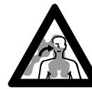
O aparelho a motor produz gases de escape tóxicos logo que o motor esteja a funcionar. Estes gases podem ser inodoros e invisíveis, e podem conter hidrocarbonetos não queimados e benzol. Nunca trabalhar com o aparelho a motor em locais fechados ou mal ventilados – também não com as máquinas com catalisadores.
