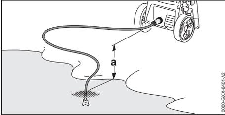
Pour que l'eau puisse être aspirée, la différence de hauteur entre le nettoyeur à pression et la source d'eau ne doit pas dépasser la hauteur d'aspiration maximale (a),
