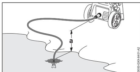
Pour que l'eau puisse être aspirée, la différence de hauteur entre le nettoyeur à pression et la source d'eau ne doit pas dépasser la hauteur d'aspiration maximale (a),
