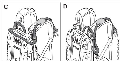
Vous pouvez ajuster la longueur du cordon de raccordement en faisant une boucle autour du sommet (illustration C) ou du côté (illustration D) de la batterie dorsale avec les fermetures à crochet et à œillet.
