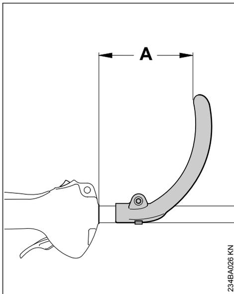
Modificando la distancia (A), se puede poner el asidero en la posición más favorable para el operario y para el caso de aplicación concreto.
