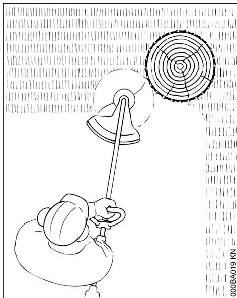
Para um "corte" macio – para um corte preciso também de bordos alcantilados à volta de árvores e estacadas – menor ferimento da casca da árvore
