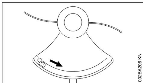
Uma seta marca a direcção de rotação das ferramentas de corte.
