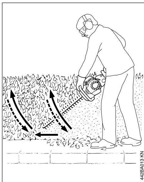
Guia el cortasetos hacia arriba y abajo en forma de arco – bajar y seguir hacia delante – y volver a guiar las cuchillas hacia arriba en forma de arco.
