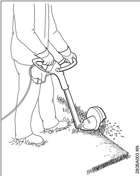
Агрегат можна швидко переобладнати на кромкоріз (див. розділ «Переобладнання агрегату на кромкоріз»).
