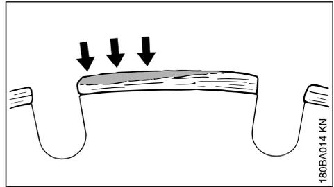
Par arêtes rapportées on entend le dépôt gris clair qui se forme en haut des segments diamantés. Ce dépôt engorge les diamants et les segments perdent leur mordant.
