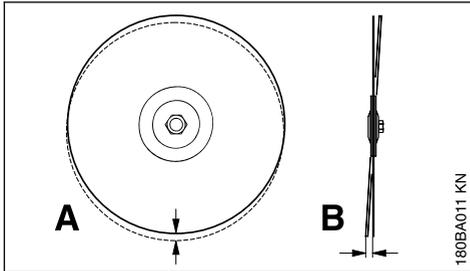
En cas de faux-rond excessif (A), les segments diamantés sont soumis à de trop fortes sollicitations et deviennent extrêmement chauds. Les contraintes thermiques peuvent causer une fissuration du corps de la lame et les segments peuvent être détremés par une surchauffe.
