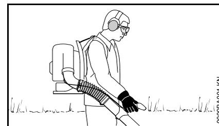
L'appareil est porté sur le dos. La main droite guide le tube de soufflage sur la poignée de commande.
