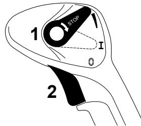
**Gás de bloqueio progressivo** – o acelerador pode ser bloqueado progressivamente: Puxar a alavanca reguladora (1) para cima até que seja alcançado o número de rotações desejado. Colocar novamente a alavanca reguladora na posição de serviço I para a desbloquear
