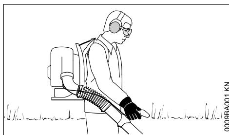
O aparelho é transportado nas costas. A mão direita conduz o tubo soprador no cabo de operação.
