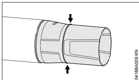
Durante o trabalho, a parte da frente da tubeira gasta-se ao raspar no chão. A tubeira é uma peça de desgaste e tem que ser substituída quando alcança a marcação de desgaste.
