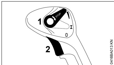
**Gas fijo sin escalones** – el acelerador se puede fijar sin escalones: empujar la palanca de ajuste (1) hacia arriba, hasta que se haya alcanzado el régimen deseado. Para liberar el enclavamiento, volver a poner la palanca de ajuste en la posición de funcionamiento I.
