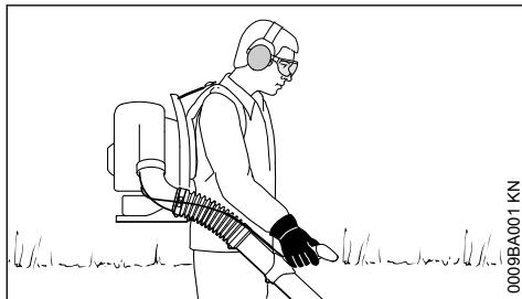
La máquina se lleva a la espalda. La mano derecha guía el tubo de soplado por la empuñadura de mando.
