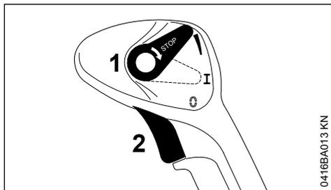
**Gás de bloqueio progressivo** – o acelerador pode ser bloqueado progressivamente: Puxar a alavanca reguladora (1) para cima até que seja alcançado o número de rotações desejado. Colocar novamente a alavanca reguladora na posição de serviço I para a desbloquear
