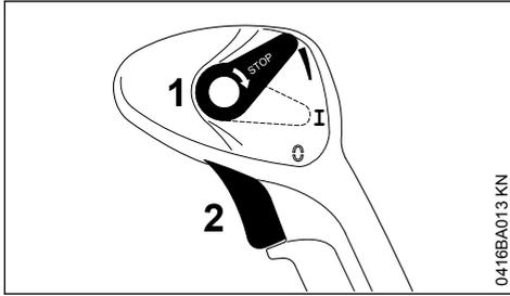
**Gas fijo sin escalones** – el acelerador se puede fijar sin escalones: empujar la palanca de ajuste (1) hacia arriba, hasta que se haya alcanzado el régimen deseado. Para liberar el encendido, volver a poner la palanca de ajuste en la posición de funcionamiento I.
