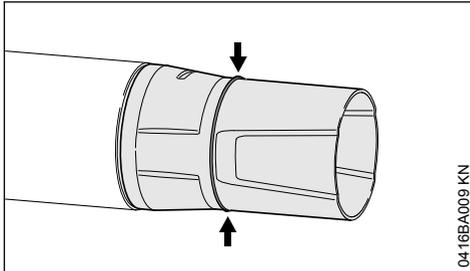
Durante el trabajo, la parte delantera de la tobera se desgasta al rozar en el suelo. La tobera es una pieza de desgaste y se ha de sustituir al alcanzarse la marcación de desgaste.
