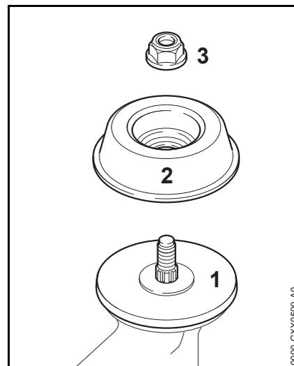
Suivant la version de l'outil de coupe, il faut utiliser en outre l'écrou (3) et le bol glisseur (2). Le disque de pression (1) doit être monté avec tous les outils de coupe.
