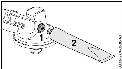
Contrôler la charge de graisse du réducteur toutes les 25 heures de fonctionnement et, si nécessaire, faire l'appoint de graisse :
