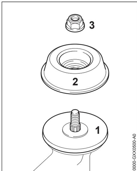
Consoante o modelo da ferramenta de corte também podem ser necessárias porcas (3) e o prato móvel (2). O prato móvel (1) tem de estar montado em todas as ferramentas de corte.
