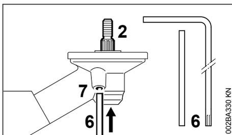
Para montar e desmontar as ferramentas de corte o eixo (2) tem que ser bloqueado com o pino (6) ou a chave de fenda angular (6). As peças estão incluídas no material fornecido e podem ser adquiridas como acessório especial.
