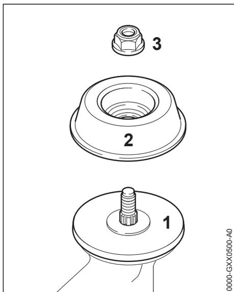
Para ello, según la ejecución de la herramienta de corte, se precisa adicionalmente la tuerca (3) y el plato de rodadura (2). El plato de presión (1) tiene que estar montado en todas las herramientas de corte.
