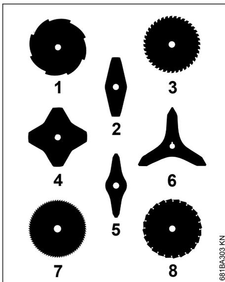
La herramientas de corte de (2, 4, 5, 6) pueden estar orientadas en el sentido que se desee – dar la vuelta periódicamente a estas herramientas para evitar un desgaste unilateral.
