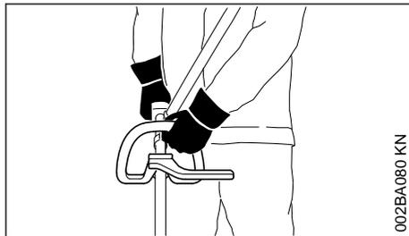
Nos modelos com cabo circular e cabo circular com arco (limitador do passo), colocar a mão esquerda no cabo circular, a mão direita no cabo de operação – também para os canhotos.
