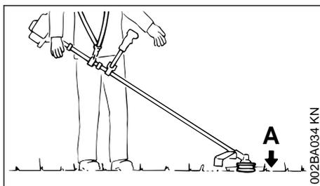
Ferramentas de corte de ervas (A) como cabeças de corte, lâminas para cortar erva e lâminas para cortar mata espessa
