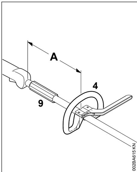
Modificando la distancia (A), se puede poner el asidero tubular cerrado en la posición más favorable para el usuario y para el caso de aplicación concreto.
