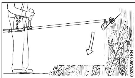
Para desbastar crescimento selvagem e bre-nhas, "imersir" a faca para cortar mata espessa de cima na planta – o material a cortar é triturado – não manter a ferramenta de corte ao mesmo tempo acima da altura das ancas.
