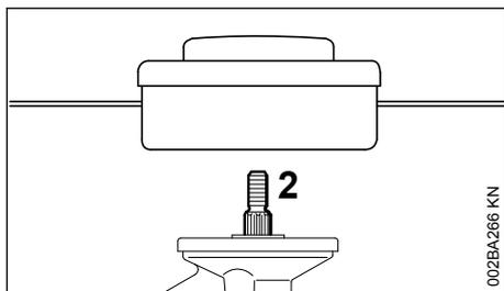
Apenas podem ser montadas cabeças de corte que são fixadas diretamente no eixo (2).
