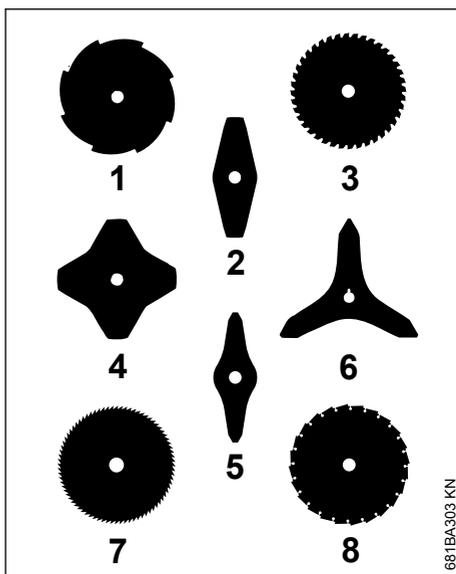
As ferramentas de corte (2, 4, 5, 6) podem estar viradas em qualquer direção – virar regularmente estas ferramentas de corte para evitar um desgaste unilateral.
