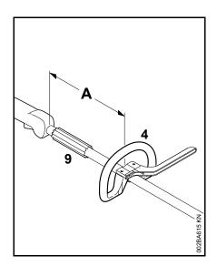
En modifiant la distance (A), on peut amener la poignée circulaire dans la position la plus commode suivant l'utilisateur et l'utilisation prévue.
