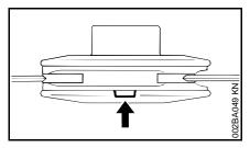
Si, sur la tête faucheuse PolyCut, l'un des témoins d'usure est cassé, du côté inférieur (flèche) : ne plus utiliser cette tête faucheuse, mais la remplacer par une tête faucheuse neuve ! **Risque de blessure** par des éclats de l'outil projetés !
