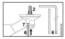
Pour le montage et le démontage des outils de coupe, il faut bloquer l'arbre (2) à l'aide du mandrin de calage (6) ou du tournevis coudé (6). Les pièces font respectivement partie du jeu de pièces joint à la livraison de la machine ou sont livrables à titre d'accessoire optionnel.
