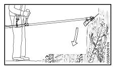
Pour l'éclaircissage des plantes sauvages et des broussailles, « plonger » le couteau à taillis dans les plantes – de telle sorte qu'elles soient hachées de haut en bas. L'utilisateur ne doit pas tenir l'outil de coupe à une hauteur supérieure à sa hanche.
