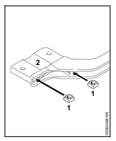
Introduire les écrous à quatre pans (1) dans la protection (2) – faire coïncider les trous ;
