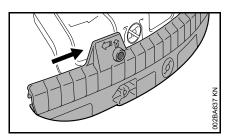
Glisser la rainure de guidage du tablier sur le rebord du capot protecteur jusqu'à ce que le tablier s'encliquette.
