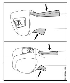
Enfoncer le blocage de gâchette d'accélérateur et accélérer – le levier du volet de starter revient dans la position de marche normale I – après un démarrage à froid, faire chauffer le moteur en donnant quelques coups d'accélérateur.
