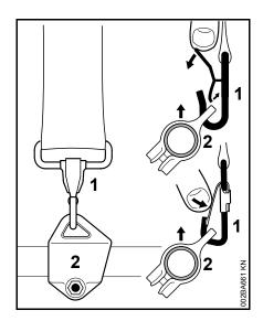
Appuyer sur la languette du mousqueton (1) et sortir l'anneau de suspension (2) du mousqueton.
