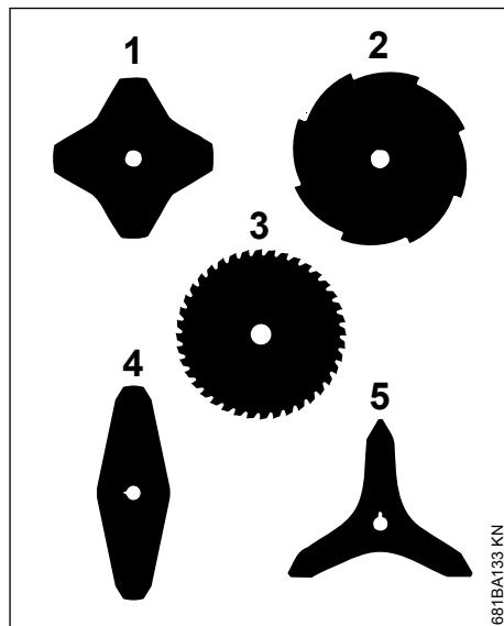
La herramientas de corte de (1, 4, 5) pueden estar orientadas en el sentido que se deseé – dar la vuelta periódicamente a estas herramientas para evitar un desgaste unilateral.
