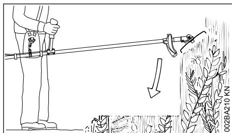
"Imergir" a lâmina de trituração de cima na planta para limpar e fragmentar crescimento selvagem e brenhas – o material cortado é triturado – não manter a ferramenta de corte acima da altura das ancas.
