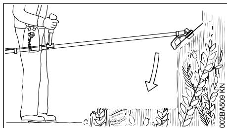
Para desbastar crescimento selvagem e brenhas, "immergir" a faca para cortar mata espessa de cima na planta para limpar e fragmentar crescimento selvagem e brenhas – o material cortado é triturado – não manter a ferramenta de corte acima da altura das ancas.
