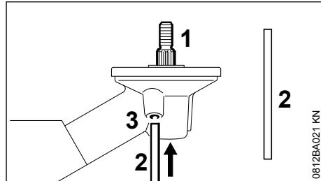
O eixo (1) tem que ser bloqueado com o pino (2) para incorporar e desmontar as ferramentas de corte. O pino está incluído no material fornecido, e pode ser adquirido como acessório especial.
