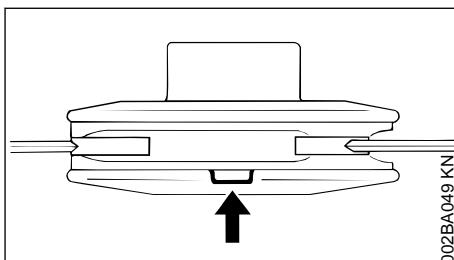
Se uma das marcações na cabeça de corte PolyCut estiver partida para baixo (seta): Já não utilizar a cabeça de corte, e substituí-la por uma nova! **Perigo de ferir-se** por peças projectadas das ferramentas!
