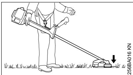
As cabeças de corte, lâminas para cortar erva, facas para cortar mata espessa e lâminas de trituração deveriam estar depositadas levemente no chão.
