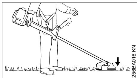
Los cabezales de corte, las hojas cortahierbas, las cuchillas cortamalezas y las cuchillas trituradoras deben tocar ligeramente el suelo.
