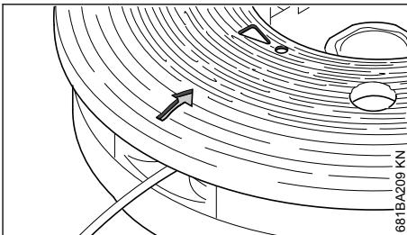
Si en el protector del DuroCut se hace visible una marca de desgaste en forma de **signo de exclamación**, no seguir utilizando el DuroCut; de lo contrario, existe el peligro de que se dañe el cabezal de corte.
