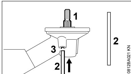
Para montar y desmontar las herramientas de corte, se ha de bloquear el árbol (1) con el pasador (2). El pasador se incluye en el volumen de suministro y se puede adquirir como accesorio especial.
