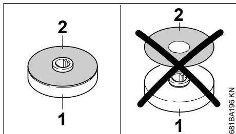
El plato de presión se compone del cuerpo (1) y un disco protector (2) imperdible montado encima.
