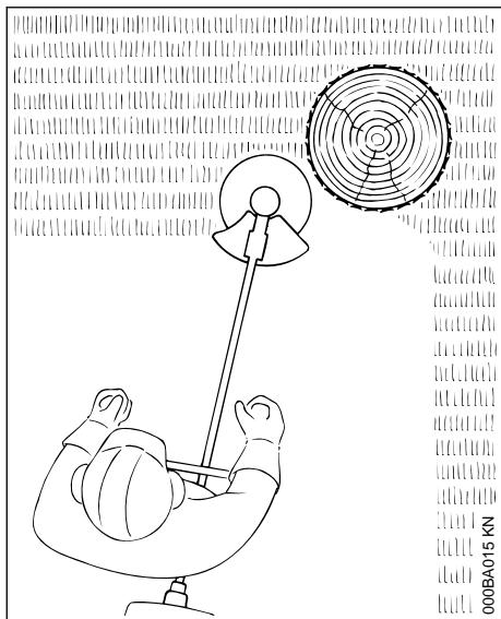
Para um "corte" suave – para cortar com precisão também bordos alcantilados à volta de árvores, estacas, etc. – menor ferimento da casca da árvore.
