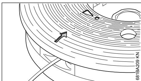
Quando uma marcação de desgaste formada como **ponto de exclamação** na protecção da DuroCut, for visível, já não utilizar a DuroCut, senão existe o perigo que a cabeça de corte seja danificada.
