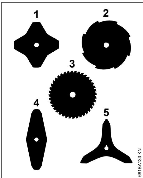
As ferramentas de corte (1, 4, 5) podem estar viradas em qualquer direção – virar regularmente
