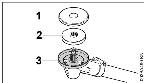
Utilizar o anel de protecção (1) para uma ótima protecção de enrolamento durante a utilização de
