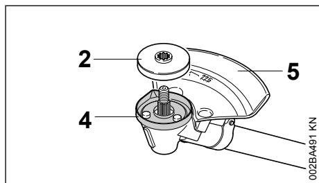
Utilizar o anel de protecção (4) unicamente para o emprego de lâminas circulares.
