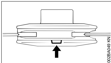
Si se ha roto una de las marcas del cabezal de corte PolyCut hacia abajo (flecha): no volver a utilizar el cabezal de corte y sustituirlo por uno nuevo. ¡**Peligro de lesiones** por piezas de la herramienta despedidas!
