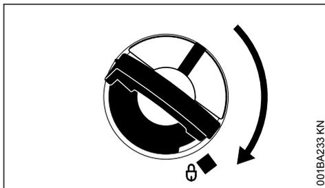
► En maintenant la pression sur le bouchon du réservoir, le tourner dans le sens des aiguilles d'une montre jusqu'à ce qu'il s'encliquette.
