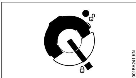
Le bouchon du réservoir est verrouillé.
