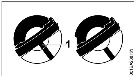
Izquierda: Parte inferior del cierre del depósito, girada – la marca del interior (1) está alineada con la marca del exterior
