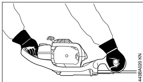
A mão esquerda no cabo de operação, a mão direita na pega do tubo do punho. Agarrar firmemente nas pegas com os polegares.
