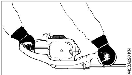
La mano izquierda, en la empuñadura de mando, y la derecha, en la empuñadura situada en la barra portacuchillas. Agarrar firmemente las empuñaduras con los pulgares.
