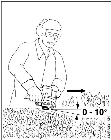
Aplicar las cuchillas en un ángulo de  $0^{\circ}$  hasta  $10^{\circ}$  – pero moviéndolas horizontalmente.
