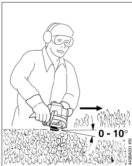
Colocar as lâminas de corte num ângulo de 0° a 10° – mas conduzi-las horizontalmente.
