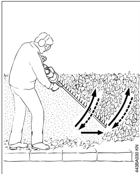
Guiar el cortasetos hacia arriba y abajo en forma de arco – bajar y seguir hacia delante – y volver a guiar las cuchillas hacia arriba en forma de arco.
