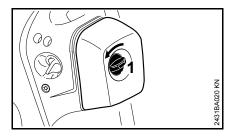
Tourner la vis de fixation du couvercle de filtre (1) vers la gauche, jusqu'à la verticale;
