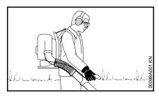
La machine se porte sur le dos. La main droite tient la poignée de commande et guide ainsi le tube de soufflage.
