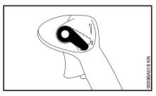
Actionner le levier de réglage en direction de 0 – le moteur s'arrête – après l'actionnement, le levier de réglage revient dans sa position initiale, sous l'effet de son ressort.
