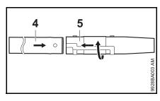
Raccorder le tube de soufflage (4) et la buse (5).
