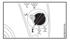
À l'actionnement de la gâchette d'accélérateur, le bouton tournant du volet de starter passe automatiquement en position de marche normale I.
