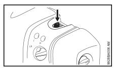
Enfoncer au moins 5 fois le soufflet de la pompe d'amorçage manuelle – même si le soufflet est rempli de carburant.
