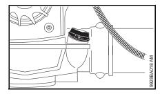
Avant de faire le plein, nettoyer le bouchon du réservoir et son voisinage, afin qu'aucune impureté ne risque de pénétrer dans le réservoir.
