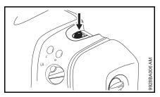
enfoncer au moins 5 fois le soufflet de la pompe d'amorçage manuelle – même si le soufflet est rempli de carburant;
