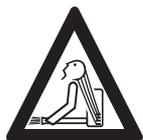
Ne pas porter des vêtements qui risqueraient de se prendre dans le bois, les broussailles ou les pièces en mouvement de la machine. Ne porter ni écharpe ou cravate, ni bijoux. Les personnes aux cheveux longs doivent les nouer et les assurer (foulard, casquette, casque etc.).
