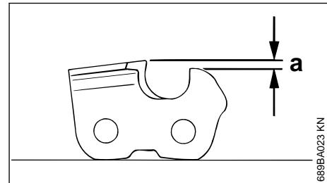
O limitador de profundidade determina a profundidade de penetração na madeira, e, por consequência, a espessura das aparas.
