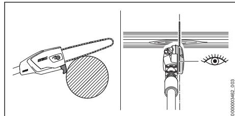
Apoyar la espada en la rama por la zona del gancho y efectuar el corte de separación desde arriba hacia abajo, de esta forma se evita que la sierra quede aprisionada en el corte. Con el indicador de dirección, la cadena de aserrado se puede aplicar con precisión.
