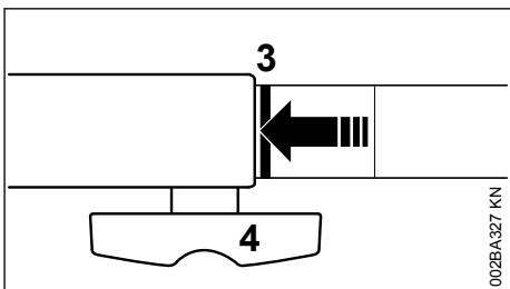
Estando correctamente introducido, la línea roja (3 = punta de flecha) tiene que estar enrasada con el manguito de acoplamiento.
