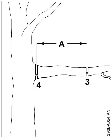
En diámetros de ramas superiores a 10 cm (4 in.), realizar primero un corte previo (3), con corte de descarga y corte de separación a una distancia (A) de aprox. 20 cm (8 in.) delante del punto de corte deseado y después realizar un corte limpio (4), con corte de descarga y corte de separación en el punto deseado
