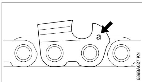
A marcação (a) do passe da corrente é gravada no sector do limitador de profundidade de cada dente de corte.
