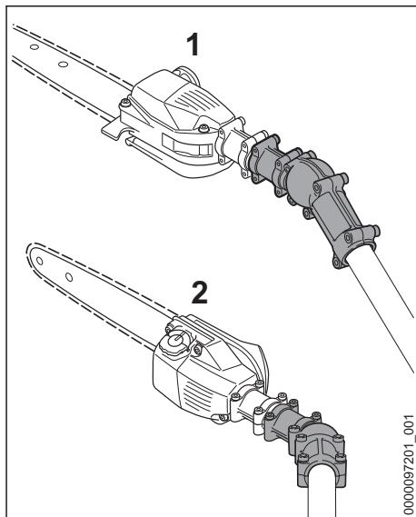
A engrenagem angular dá desvio angular de 30° à ferramenta de corte em comparação com a haste.
