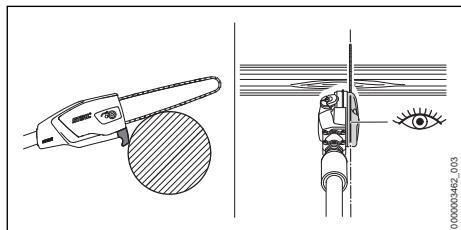
Encostar a guia na zona do gancho no ramo, e efetuar o corte de separação de cima para baixo – isto evita que a corrente fique presa no corte. O prolongador de tubo permite posicionar a corrente com precisão.
