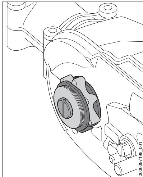
La rueda de cadena se acciona por medio de un embrague de resbalamiento. El cambio de la rueda de cadena lo ha de realizar un distribuidor especializado.
