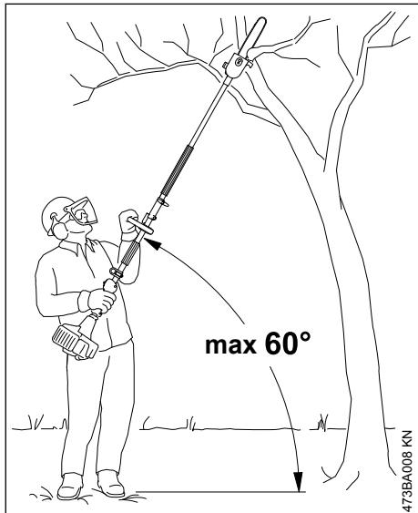
Manter o aparelho a motor inclinado, não permanecer diretamente por baixo do ramo a cortar.
