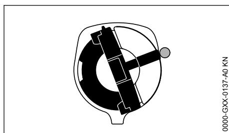
As marcações na tampa do depósito e no depósito do óleo têm de estar alinhadas
