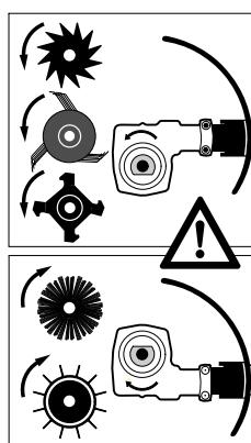
Posicionar a engrenagem de tal modo nas ferramentas para varrer e limpar que o eixo se encontre em cima da haste.
