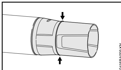
Pendant le travail, la partie avant de la buse est usée par le contact abrasif avec le sol. La buse est une pièce d'usure et doit être remplacée lorsque la marque d'usure est atteinte.
