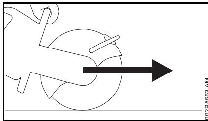
O cortador de ferro e pedra puxa para a frente a partir da posição do utilizador quando o disco de corte toca desde a parte de cima no objeto a cortar.
