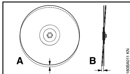
Um desvio demasiado grande na rotação (A) irá sobrecarregar alguns segmentos de diamante, que também aquecem. Isto pode causar rachaduras devido à tensão na lâmina principal ou o recozimento de alguns segmentos.
