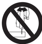
Conduzir o disco de corte a direito na fenda de corte, sem emperrar nem sujeitá-lo a carga lateral.
