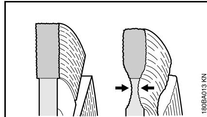
Al cortar superficies de calzada, no penetrar en la capa portante (con frecuencia, grava) – el corte en la grava se puede reconocer por el polvo claro – en este caso, puede producirse un desgaste de núcleo excesivo – ¡peligro de rotura!
