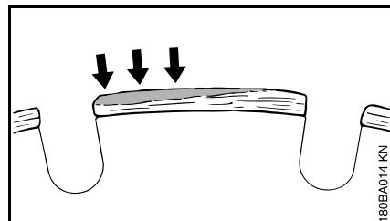
As rebarbas formam-se como um revestimento cinzento-claro nos lados superiores dos segmentos de diamante. Este revestimento junta-se aos diamantes nos segmentos e gasta os segmentos.
