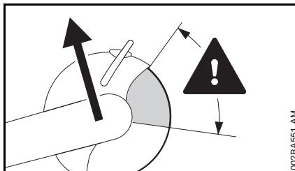
Durante um ressalto (kickback), o cortador de ferro e pedra é lançado de forma repentina e descontrolada na direção do utilizador.
