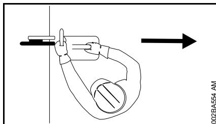
Nenhuma parte do corpo deve contactar com a parte giratória prolongada do disco de corte. Providenciar bastante espaço livre, particularmente em escavações criar bastante espaço para o utilizador e para a queda da peça a cortar.
