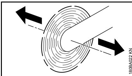
Si se mueve una tronzadora con un disco en rotación en el sentido de la flecha, se produce una fuerza que intenta volcar la máquina.
