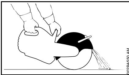
Ajustar correctamente el protector para el disco: desviar las partículas de material del usuario y de la máquina.
