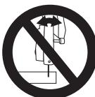
Guiar el disco en línea recta hacia el intersticio de corte, no ladearlo o someterlo a ninguna carga lateral.
