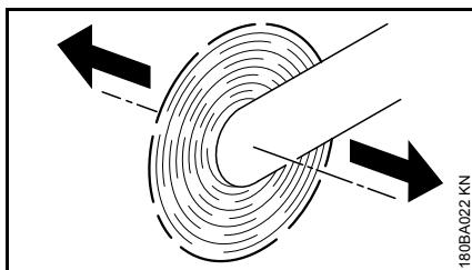
Se um cortador de ferro e pedra com um disco de corte em rotação for movimentado na direção da seta, produz-se uma força que tenta de bascular o aparelho.
