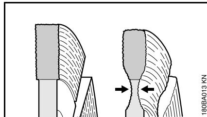
Ao cortar os pavimentos das faixas de rodagem, não penetrar na camada de suporte (muitas vezes brita) – o corte na brita pode ser reconhecido pelo pó claro – ao mesmo tempo pode ocorrer um desgaste excessivo da parte central – **perigo de rutura!**
