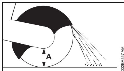
La forma de proceder está en función del diámetro exterior del tubo y la profundidad de corte máxima del disco de tronzar (A).
