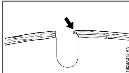
Si se sigue trabajando con segmentos romos, éstos pueden ablandarse a causa del alto desarrollo térmico – la hoja básica se pone incandescente y pierde su rigidez – ello puede originar tensiones que se pueden detectar claramente por el tambaleo del disco. No se debe seguir empleando el disco – **¡peligro de accidente!**
