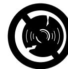
Verificar o disco de corte com mais frequência – substituir imediatamente se apresentar ruturas, curvaturas ou outros danos (por exemplo, sobreaquecimento) – a rutura provoca **perigo de acidentes!**
