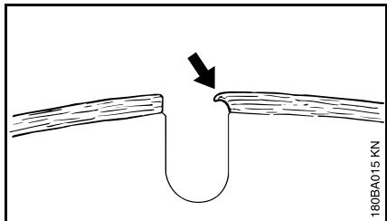
Se continuar a trabalhar com segmentos gastos, estes podem amolecer devido ao elevado desenvolvimento de calor – a lâmina principal recoze e perde a sua solidez – isto pode conduzir a escoramentos; é nitidamente reconhecível pelos movimentos oscilantes do disco de corte. Não voltar a utilizar o disco de corte – **perigo de acidentes!**
