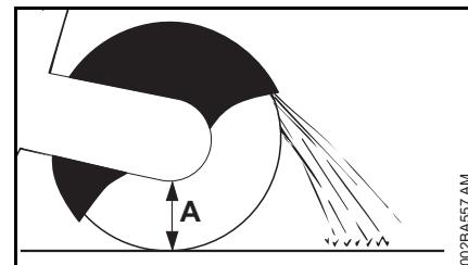
O modo de procedimento depende do diâmetro exterior do tubo e da profundidade de corte máxima possível do disco de corte (A).
