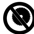
Nunca utilizar lâminas circulares, ferramentas de metal duro, ferramentas de recuperação, ferramentas para cortar madeira ou outras ferramentas dentadas - **perigo de ferimentos mortais!** Os dentes de uma lâmina circular podem engatar no material durante o corte, contrariamente à remoção uniforme de partículas durante a utilização de discos de corte. Isto causa um comportamento de corte agressivo e pode conduzir a forças de reação descontroladas e extremamente perigosas do aparelho (sacudir).
