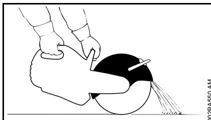
**Regular corretamente a proteção para o disco de corte:** Dirigir as partículas do material no sentido oposto ao utilizador e ao aparelho.
