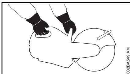
**Segurar o aparelho a motor sempre com as duas mãos:** A mão direita na pega traseira – também no caso de canhotos. Abranger bem o tubo do punho e o cabo da mão com os polegares para conseguir uma condução segura.
