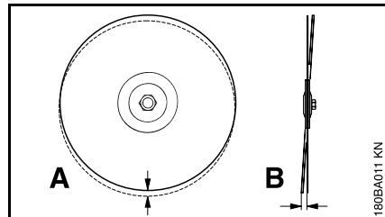
Una excentricidad radial demasiado alta (**A**) sobrecarga distintos segmentos de diamantes que, en consecuencia, se calientan. Ello puede originar fisuras por tensión en la hoja básica o la incandescencia de algún que otro segmento.
