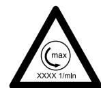
A rotação admissível do disco de corte tem de ser igual ou superior à rotação máxima do fuso do cortador de ferro e pedra – vide o capítulo "Dados técnicos".
