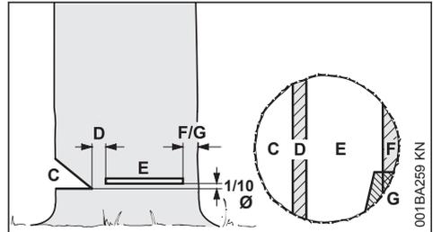
L'entaille d'abattage (C) détermine la direction de chute.
