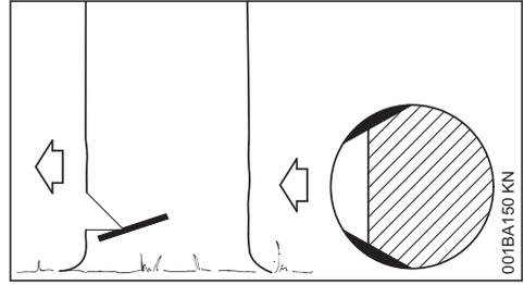
En cas de bois à longues fibres, les entailles dans l'aubier empêchent l'éclatement de l'aubier à l'abattage de l'arbre – exécuter ces entailles des deux côtés du tronc, au niveau de la base de l'entaille d'abattage, sur une largeur correspondant à env. 1/10 du diamètre du tronc – en cas de troncs de très grand diamètre, exécuter des entailles d'une profondeur maximale égale à la largeur du guide-chaîne.
