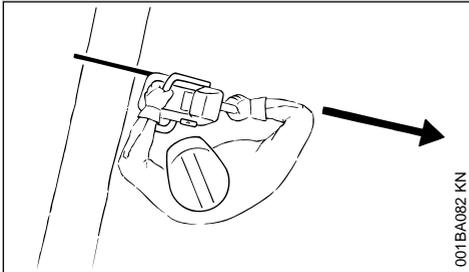
Tenir la tronçonneuse de telle sorte qu'aucune partie du corps ne se trouve dans le prolongement du **plan de basculement** de la chaîne.
