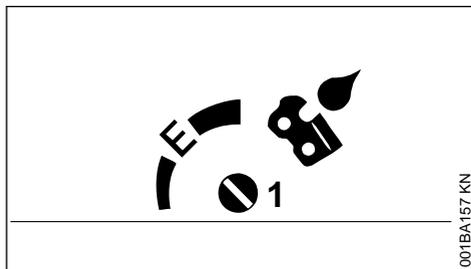
Le boulon de réglage (1) (sur la face inférieure de la machine) permet de régler le débit d'huile suivant besoin.
