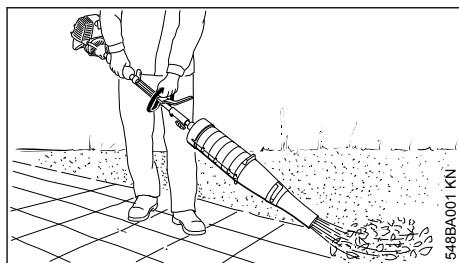
Agarrar siempre la máquina por las empuñaduras con ambas manos. La mano derecha, en la empuñadura de mando; la izquierda, en la empuñadura del vástago – también los zurdos. Agarrar firmemente las empuñaduras con los pulgares.
