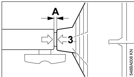
Estando correctamente colocado, la rejilla protectora (3) tiene que estar enrasada con el manguito de acoplamiento (intersticio A, 5 mm, como máximo).
