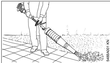
Segurar sempre no aparelho a motor com as duas mãos nas pegas. A mão direita no cabo de operação, a mão esquerda na pega – mesmo no caso de canhotos. Agarrar firmemente nas pegas com os polegares.
