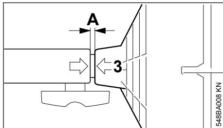
Quando inserida corretamente, a grade de proteção (3) tem de estar alinhada com a manga de acoplamento (folga A com 5 mm no máx.).
