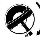
Dans le cas du bouchon de réservoir à ailette rabattable (verrouillage à baïonnette), le présenter correctement, le faire tourner jusqu'en butée et rabattre l'ailette.
