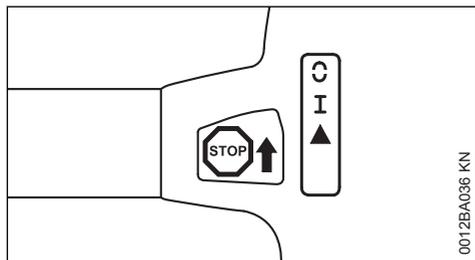
**STOP** ou ☺ – pour couper le contact, il faut pousser le levier de commande universel en direction de **STOP** ou ☺. Lorsqu'on le relâche, le levier de commande universel revient en position **I**, sous l'effet de son ressort.
