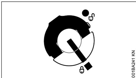
Le bouchon du réservoir est verrouillé.
