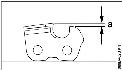
Le limiteur de profondeur détermine la profondeur de pénétration dans le bois et, par conséquent, l'épaisseur des copeaux.
