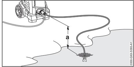
Pour que l'eau puisse être aspirée, la différence de hauteur entre le nettoyeur à pression et la source d'eau ne doit pas dépasser la hauteur d'aspiration maximale (a),
