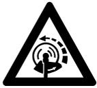
Lorsqu'on arrête la machine, l'outil de coupe tourne encore pendant quelques instants – **par inertie !**
