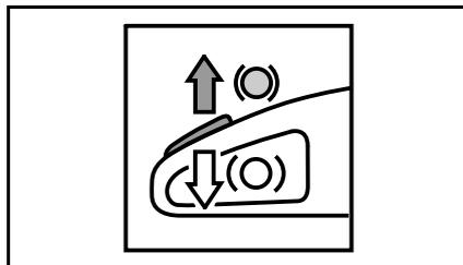
Der Auslösemechanismus der QuickStop Super Nachlaufbremse ist ohne weitere Bedienungselemente in die Gashebelsperre (hinterer Handgriff) integriert. Ein wesentlicher Vorteil bei der Arbeit ist, dass die Sägekette (z.B. beim Transport) mit laufendem Motor automatisch blockiert ist, solange der hintere Handgriff losgelassen ist.
