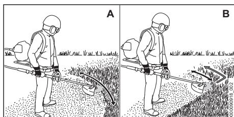
**Κοπή χόρτου με κεφαλή κοπής (Α)**
