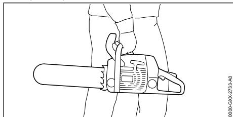
■ Después de que el motor hayan estado en funcionamiento, el silenciador y el motor pueden estar calientes. El usuario puede quemarse.
