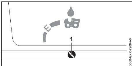
Si el tornillo de ajuste de la bomba de aceite (1) está en la posición E (Ematic), el caudal de
