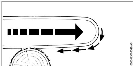
Se o trabalho for efetuado com a parte inferior da guia, a motosserra é atirada para longe do utilizador.
