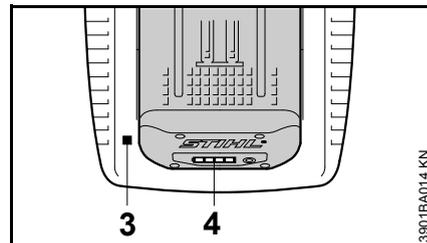
Le voyant (3) sur le chargeur s'allume lorsque la batterie est insérée, voir le chapitre « Voyants sur le chargeur ».
