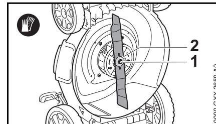
Vérifier systématiquement la vis de fixation (1) et la rondelle (2) lors du remplacement de la lame de coupe.
