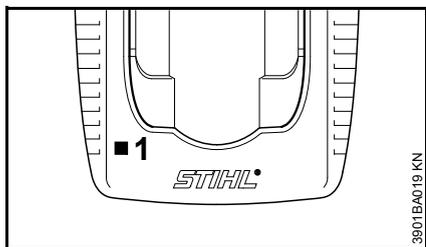
Après le branchement du chargeur sur l'alimentation électrique, un auto-test a lieu. Au cours de cette procédure, la diode électroluminescente (1) du chargeur s'allume env. 1 seconde de couleur verte, puis de couleur rouge et s'éteint.
