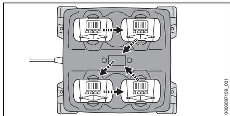
Ce chargeur permet de charger jusqu'à quatre batteries à la suite. Le chargement commence avec la batterie qui est insérée en premier et suit le schéma ci-dessus. Si une batterie particulière ne peut pas être chargée pour une raison quelconque, cette batterie est ignorée et le processus de charge se poursuit avec la batterie suivante.
