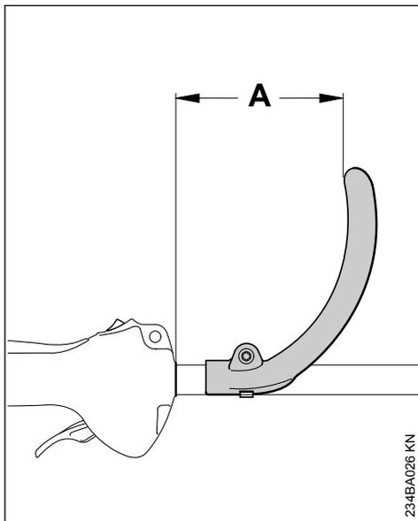
Modificando la distancia (A), se puede poner el asidero en la posición más favorable para el operario y para el caso de aplicación concreto.
