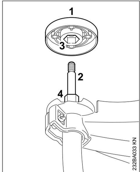
El plato de presión (1) forma parte del volumen de suministro del DuroCut 5-2 y PolyCut 6-3. Se necesita para utilizar estos cabezales de corte.
