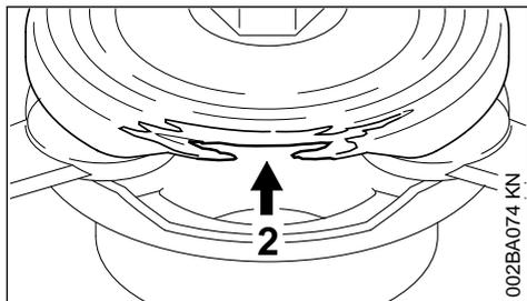
sobresale hacia dentro (2; flecha), entonces ya no se deberá seguir utilizando el PolyCut 6-3 – sustituirlo por un cabezal de corte nuevo.
