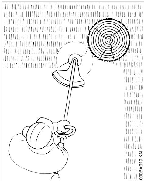
Para um "corte" macio – para um corte preciso também de bordos alcantilados à volta de árvores e estacadas – menor ferimento da casca da árvore
