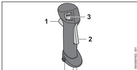
Gâchette d'accélérateur (1), verrouillage de la gâchette d'accélérateur (2) et interrupteur d'arrêt (3)
