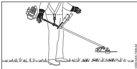
La lame de coupe circulaire doit planer à une hauteur d'environ 8 in. (20 cm) au-dessus du sol.
