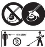
Föremål kan slungas iväg i alla riktningar eller studsa. För att minska risken för att användaren skadas av ivägslungade föremål får du aldrig använda en motorlie utan korrekt konfigurerat och korrekt installerat skydd. Åskådare ska stå på minst 15 m (50 ft.) avstånd.
